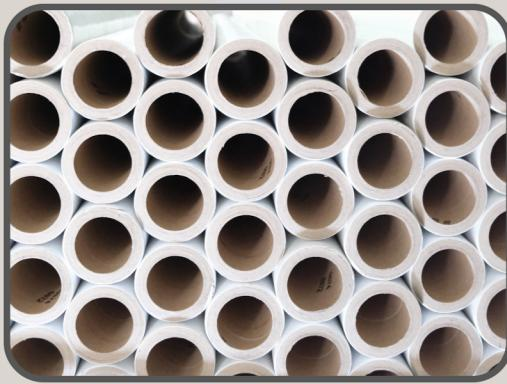
Üretilen bu ürünler streç film , alüminyum folyo , fırın pişirme kağıdı , kağıt havlu göbekleri olarak kullanılmaktadır. Bunun yanı sıra tekstil endüstrisinde kumaş , iplik , halı gibi ürünlerde kullanılmaktadır. Bu şekilde bu ürünleri son müşterilere ulaştırmış olurlar . Bu makinelerde üretilen kağıt borular bahse konu ürünlerin üreticisi olan fabrikalara ham madde olarak girerler ve üretilen ürünler ile beraber sevk edilmektedirler.
